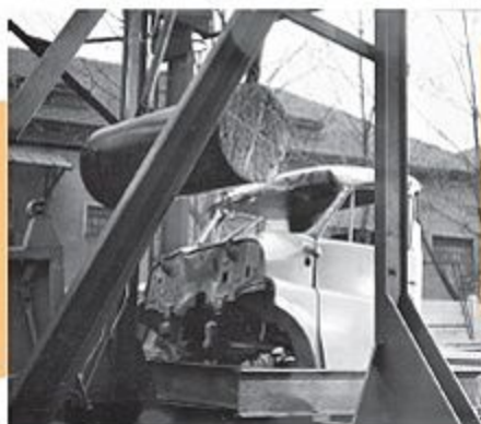
Skúška pasívnej bezpečnosti kabíny nákladného automobilu na nádvori závodu Tatra Bratislava (archív Ivan Šuster)
